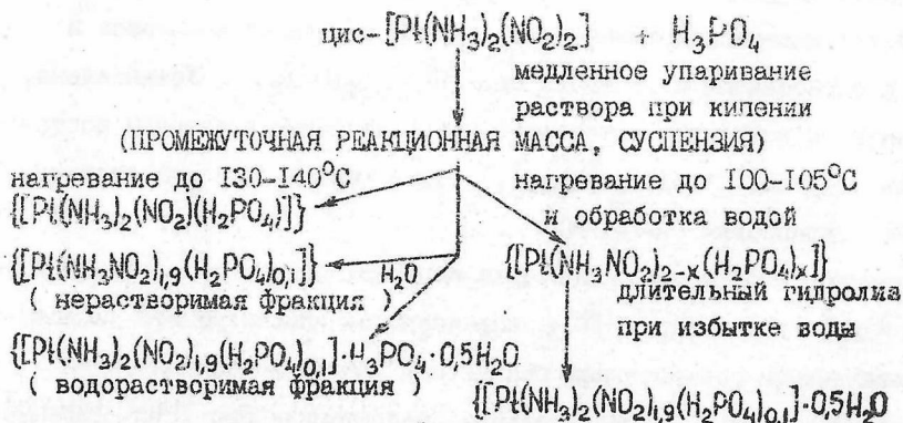
Рис. 5. Схема превращений \text{cis-}[\text{Pt}(\text{NH}_3)_2(\text{NO}_2)_2] в растворах фосфорной кислоты при соотношении компонентов, близком к эквивалентному.
